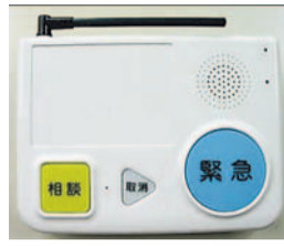
▲緊急通報装置
