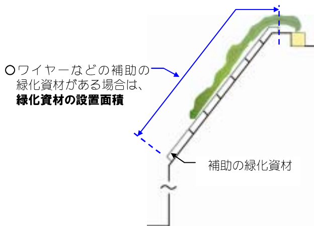
図 1-1-14 補助の緑化資材を用いる場合の算出方法 (登はん型、下垂型)
