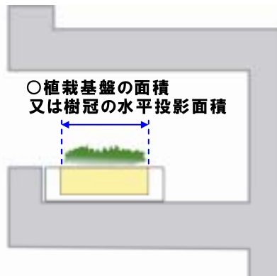
図 1-1-8 可動式の植栽基盤を用いる場合の算出方法
