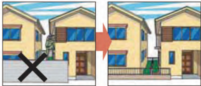
▲ブロック塀が死角をつくり、侵入の足場ともなる
