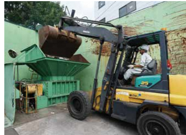
破袋機 収集されたプラスチックの収集袋を破いて選別コンベヤに送ります。
