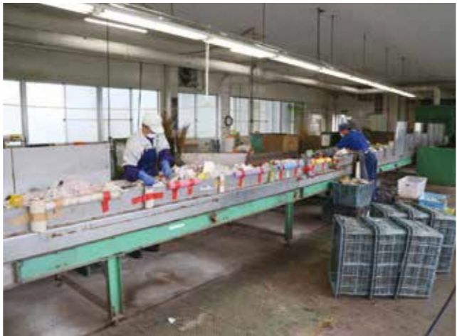
選別コンベヤ 手作業により、プラスチックの中からペットボトルと異物を選別します。
