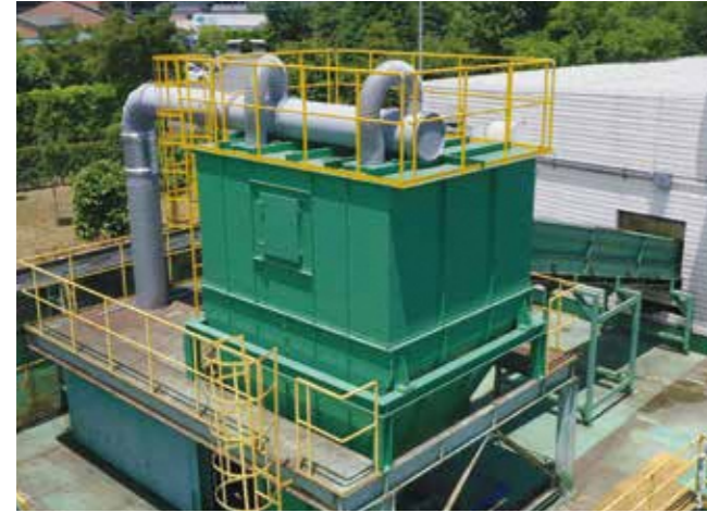
風力選別機 風の力を利用してプラスチックと残渣(異物)に選別します。
